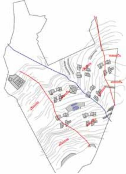
Direction des écoulements d'eau sur le site et espaces de collecte des noues
